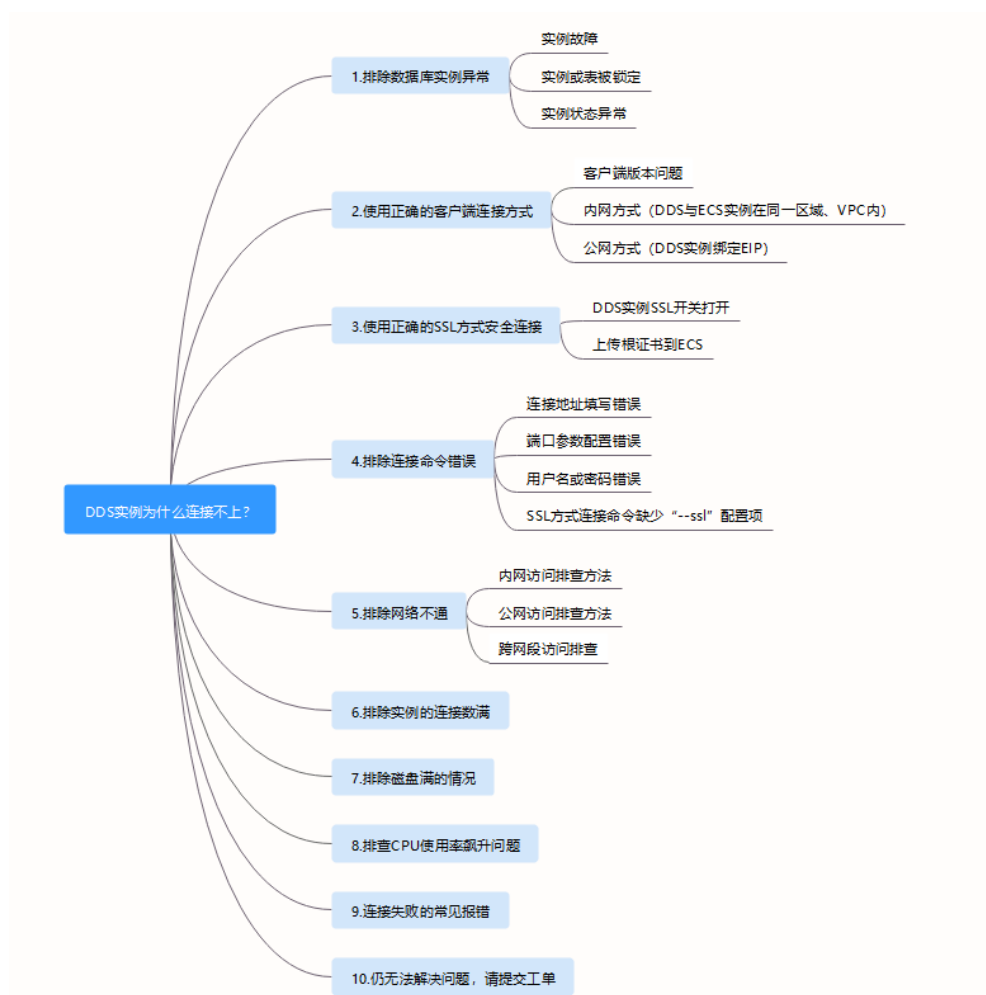
Figura 22-4 Localización de fallos de conexión de instancia
